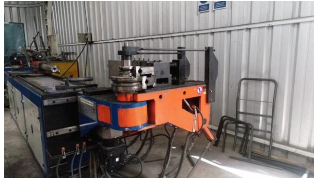
Figura 6: Dobladora robotizada de tubería
