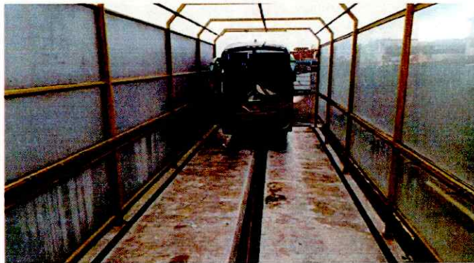
Figura 8: proceso de prueba de estanqueidad en cámara de lluvia
