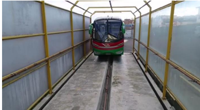
Figura 9: proceso de prueba de estanqueidad en cámara de lluvia
